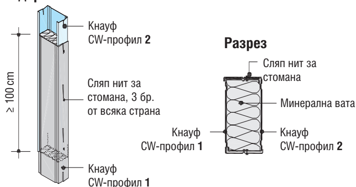
Снаждане на вертикалните профили
